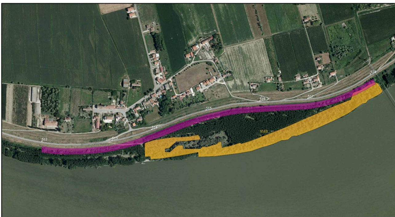
Figura 24. Ortofoto dell'area d'intervento (complessivi m 1.200) con l'inserimento dell'occupazione di cantiere (evidenziata con colore viola) e delle componenti ambientali censite (habitat 91E0* evidenziato con colore giallo)
