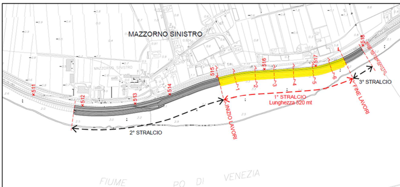
Figura 9. Planimetria con evidenza (in colore giallo) il tratto di diaframma in progetto (I stralcio) - estesa di 510 m.
