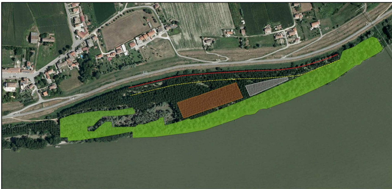
Figura 26. Ortofoto dell'area d'intervento (l stralcio evidenziato con linea rossa) con l'inserimento dell'occupazione di cantiere (evidenziato con linea gialla) e delle componenti ambientali censite (habitat 91E0 evidenziato con colore verde) – si nota come l'estremità di valle del diaframma è traslata verso monte rispetto al tracciato previsto nel P.F.T.E.
