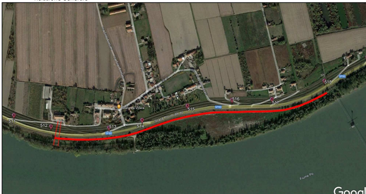
Figura 8. Planimetria con ubicazione dello sviluppo complessivo del diaframma (1.200 m).
